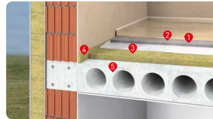
ПРИКЛАД ЗАСТОСУВАННЯ Звукова ізоляція «плаваючої підлоги»
