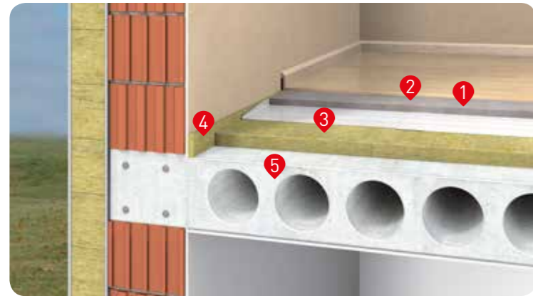
ПРИКЛАД ЗАСТОСУВАННЯ Звукова ізоляція «плаваючої підлоги»
